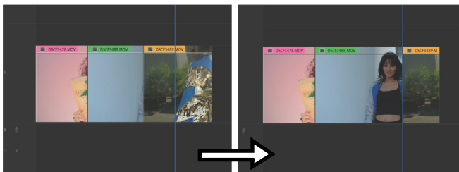
画像 4a: 緑のクリップを長くして、青いライン (再生ヘッド) に届かせる必要があります。 画像 4b: SHIFT+Qで緑のクリップを右に延長し、オレンジのクリップの半分を上書きします。
